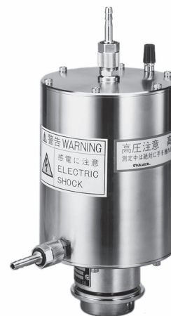
図1 電離箱 ( 1500\text{cm}^3 )
